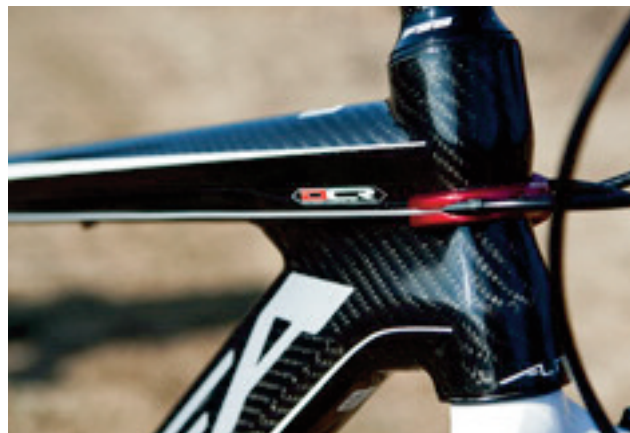
Vtipně a prakticky je vyřešeno vedení lanek, které neodírá rám při točení řídítky.
