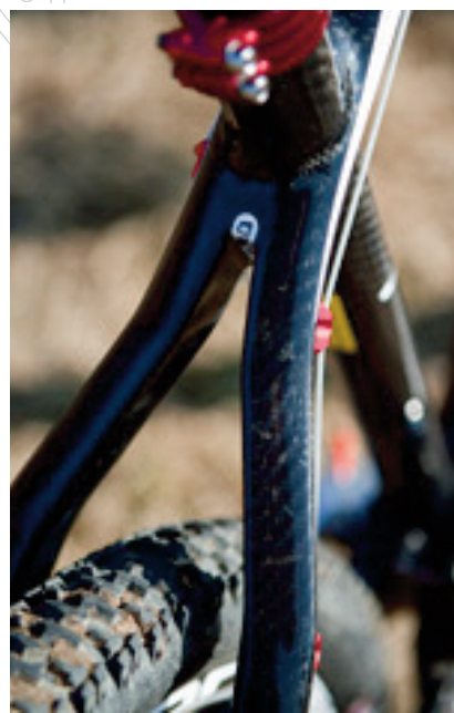
Vedení lanek a elegantní vytvarování zadní vidlice.
