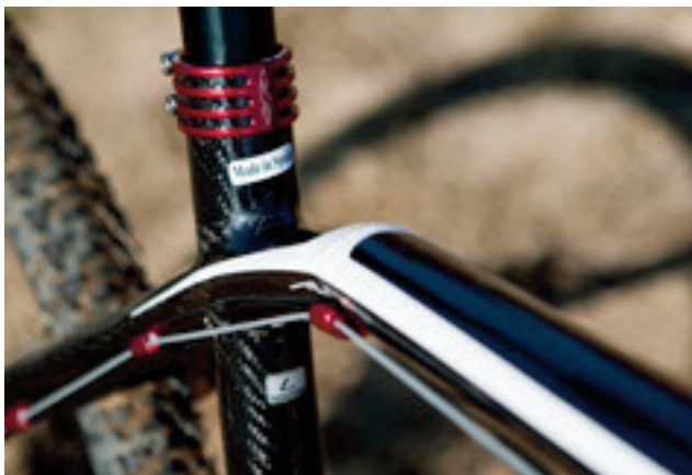
Rám zaujme hlavně zalomením spodní rámové trubky.
