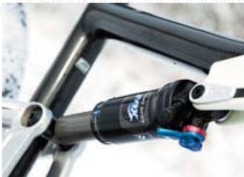
Tlumič Fox Float – RP23 je vybavený třístupňovým vypínatelným systémem Propedal proti pohupování.
