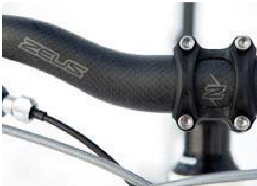
Z dílen Orbey pocházejí představec a karbonové vlašťovky o šířce 640 mm.
