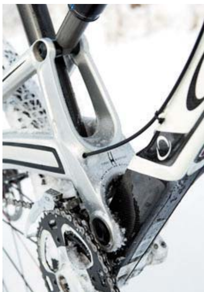
Odpružení u Orbej pracuje na jednočepovém zavěšení.
