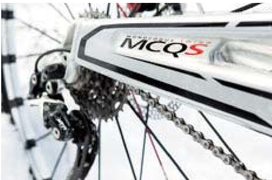
Zadní stavba je vyrobena z duralu 7075, několik navzájem posvařovaných profilů je výrobcem udáváno jako svařovaný monokok.
